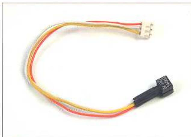
**8** In questa immagine vediamo il montaggio del sensore ottico terminato. Dobbiamo verificare di aver saldato i fili con l'ordine corretto, identificandoli con il loro colore e assicurandoci che la giunzione sia sufficientemente robusta.
