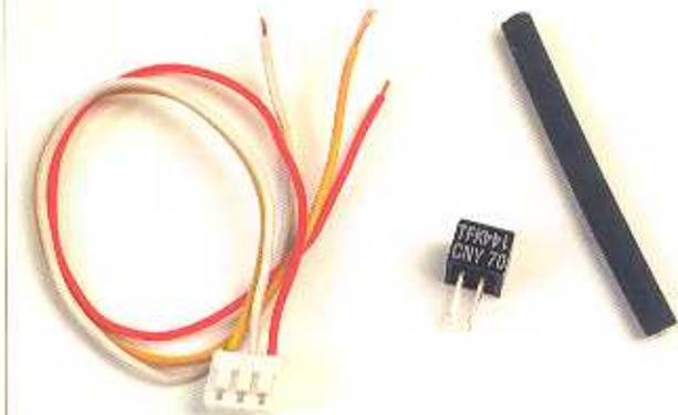
**1** Spiegheremo ora il montaggio di un altro sensore ottico tipo CNY70. Per realizzare questo montaggio, avremo bisogno del sensore, di un cavo con connettore volante femmina a tre fili e di un pezzo di tubetto termorestringente da 4,5 cm.
