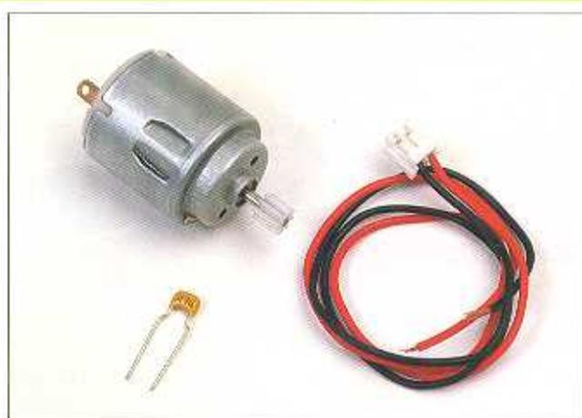
**1** Ora prepareremo il motore che controllerà il movimento di salita e discesa del braccio di Pathfinder. A questo scopo abbiamo a disposizione un condensatore che svolgerà la funzione di filtro, e un cavetto con un connettore volante.
