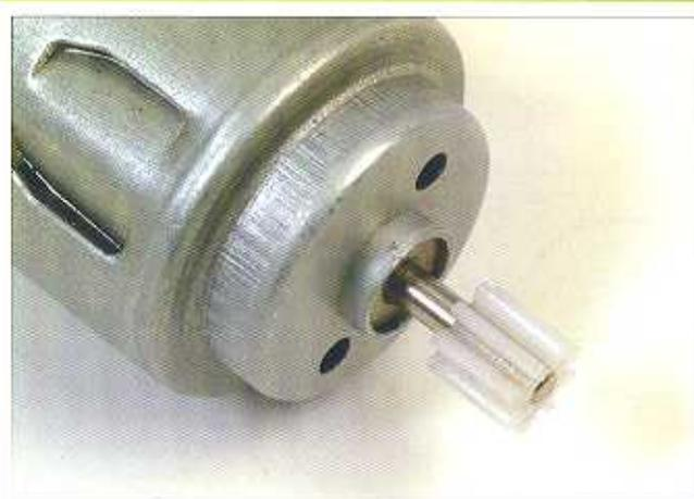
**2** Prima di realizzare le saldature sopra i terminali del motore, dobbiamo fare una modifica alla posizione del pignone del motore montato sull'asse. Sarà necessario spostarlo di qualche millimetro verso l'interno.
