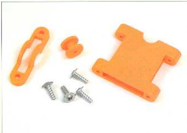
**1** I pezzi che vediamo nella figura serviranno per il meccanismo di controllo del braccio di Pathfinder. Essi saranno la base di appoggio del braccio, mediante una cinghia e una puleggia, mentre il motore permetterà a Pathfinder di sollevare e abbassare il braccio.
