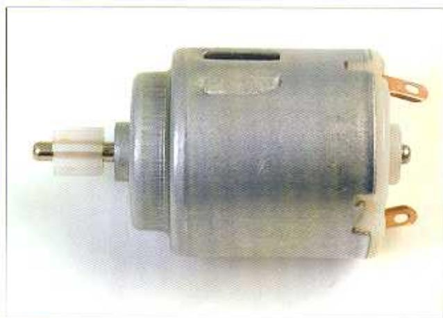
**4** Un altro modo per fare arrivare il pignone nella sua posizione, consiste nell'appoggiare il motore su di una superficie dura, che possieda un foro attraverso il quale possa passare l'asse. Batteremo leggermente sulla parte posteriore del motore fino a muovere il pignone.
