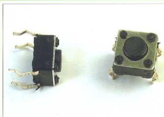
**1** Questi due pulsanti miniaturizzati ci permetteranno di attivare manualmente i modi di scrittura e riproduzione audio di Pathfinder, per caricare facilmente i messaggi che in seguito saranno riprodotti dal robot.
