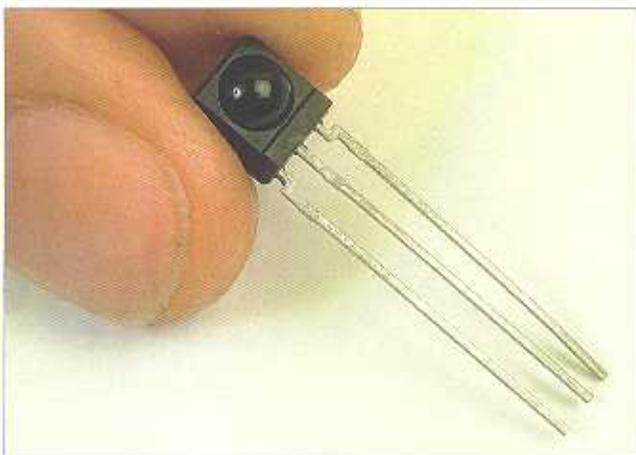
**1** Questo sensore è un rilevatore di infrarossi. Questo dispositivo capterà qualsiasi segnale emesso da un telecomando che funzioni con infrarossi. Grazie a questo sensore potremo gestire Pathfinder mediante un telecomando convenzionale, con cui potremo mettere in marcia o fermare il robot.
