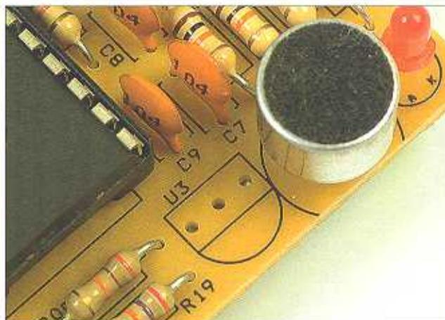
**2** Dobbiamo montare il sensore sulla scheda audio con l'orientamento corretto. Nella scheda troviamo un simbolo nella posizione U3 che indica il verso d'inserzione di questo sensore.
