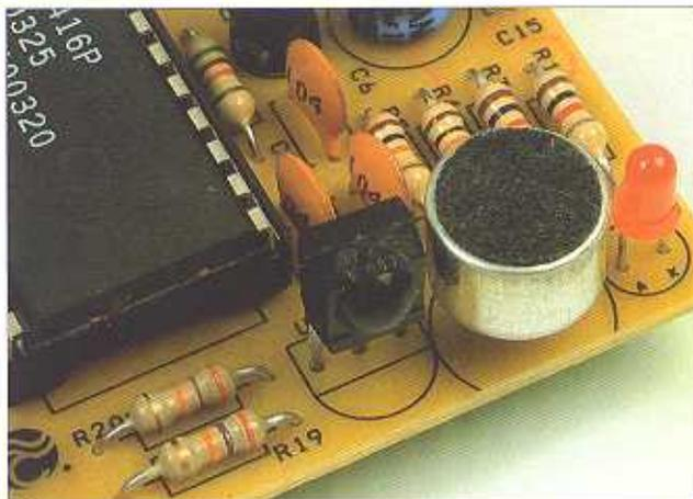
**7** Nell'immagine possiamo vedere il sensore a infrarossi correttamente saldato. La sua posizione si trova nella parte superiore della scheda. Grazie a questo, il sensore si troverà sulla parte alta del robot e potrà ricevere facilmente le emissioni a infrarossi che arriveranno dal telecomando.
