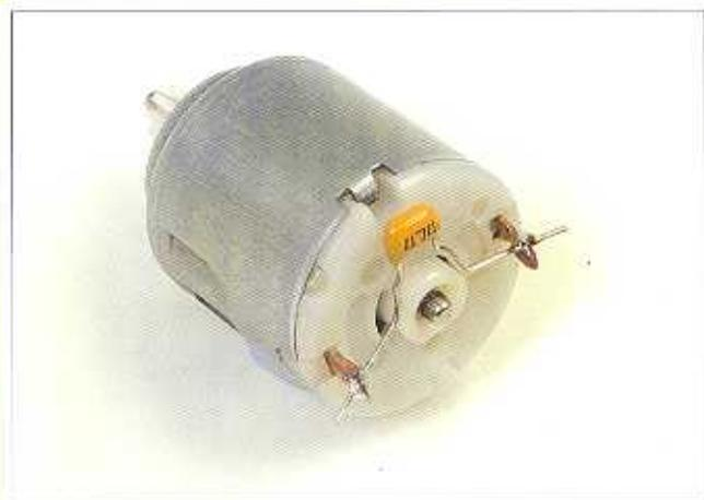
**5** A questo punto potremo saldare i componenti. Per primo salderemo il condensatore sui due terminali del motore. Il condensatore ha un valore di 470 nF e non ha polarità, quindi potremo utilizzare qualsiasi verso di inserzione.
