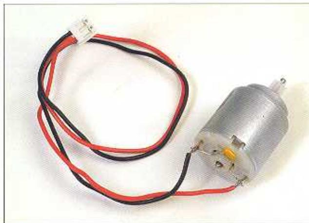
**8** Nell'immagine possiamo vedere il motore del braccio a montaggio ultimato. Questo motore dovrà ingranare con il meccanismo che servirà per muovere il braccio del robot. Verrà controllato mediante la scheda di controllo del braccio e della pinza di Pathfinder.
