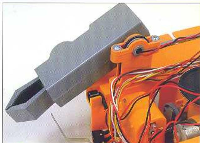
**7** Utilizzeremo le tre viti di cui disponiamo per chiudere il coperchio del braccio. Due delle viti fermeranno la zona della pinza e la terza eviterà che il coperchio si apra dalla zona posteriore.
