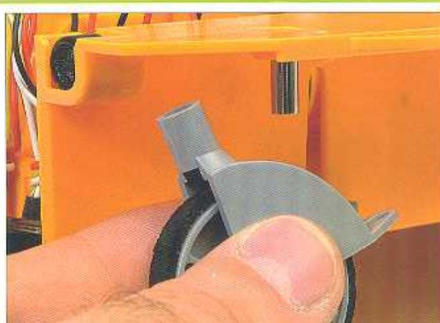
**2** Prima di montare le bielle sul telaio di Pathfinder, dobbiamo eseguire alcune modifiche sulla configurazione nel modo ruote. Per prima cosa dobbiamo togliere le ruote di direzione del robot, lasciando solo i bulloni avvitati sul telaio.
