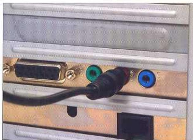
**6** Disponiamo, infine, di un terzo collegamento che si farà con il cavo di connessione di Pathfinder. Si tratta di un connettore tipo JACK, che servirà per trasmettere il suono del robot al computer. Questo connettore si inserirà all'ingresso del microfono della scheda audio del computer.
