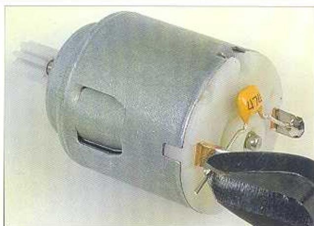
**4** Dopo aver saldato il condensatore sui terminali del motore, è probabile che sia necessario tagliare la parte in eccesso dei reofori. A questo scopo utilizzeremo un piccolo tronchesino o un paio di forbici da elettricista.
