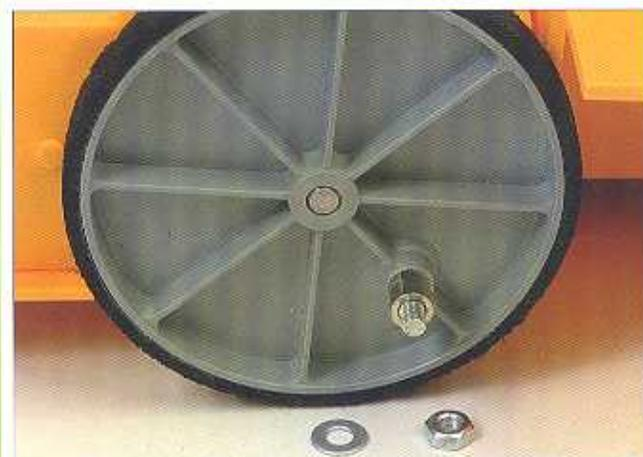
**3** Per poter montare le bielle di trazione delle zampe, dobbiamo togliere il dado e la rondella che si trovano montati sulle due ruote posteriori di trazione del robot. Dopo aver montato le bielle, fisseremo nuovamente sia le rondelle che il dado.
