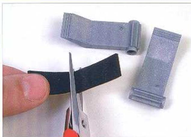
**2** Il primo passo consisterà nel tagliare la gomma adesiva in due pezzi uguali; questi pezzi verranno montati nella parte interna di ogni pinza per non lasciare scivolare gli oggetti all'interno della stessa, mentre il robot li trasporta.
