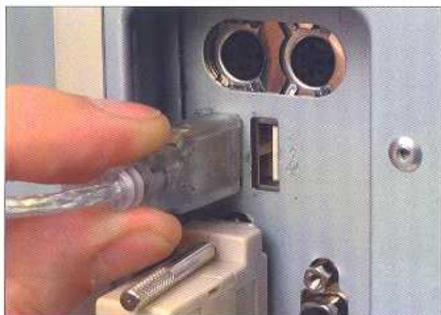
**5** Mediante il connettore tipo USB trasmetteremo l'immagine della telecamera WEB del robot verso il PC. Scegliere un connettore tipo USB libero sul nostro PC e collegheremo a esso il terminale USB del cavo. Questo cavo può essere solamente in un verso.
