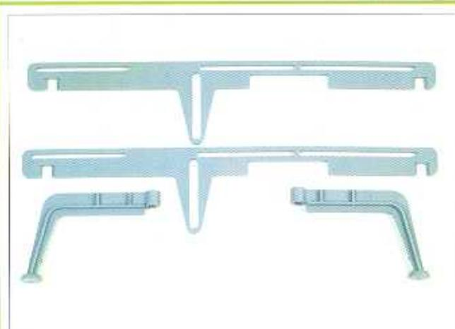
**1** Modificheremo la meccanica di Pathfinder per la sua configurazione in modo esapodo. Per questa configurazione abbiamo bisogno di nuovi componenti meccanici. Nell'immagine sono raffigurate le prime due zampe del robot e le due bielle che serviranno per il movimento di queste zampe.
