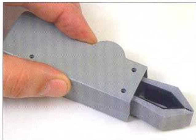
**5** Monteremo le due metà della pinza in modo che quando la cremagliera è a fondo-corsa verso l'interno del braccio la pinza rimanga chiusa. Le due parti della pinza devono essere simmetriche, inserite sugli assi del braccio e ingranare con la cremagliera.
