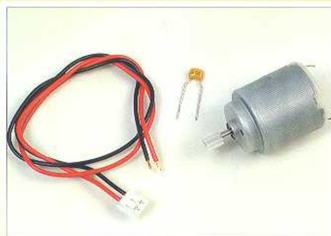
**1** Monteremo ora l'ultimo motore di cui dispone Pathfinder, che avrà il compito di controllare l'apertura e la chiusura della pinza. Abbiamo a disposizione il motore, un condensatore da 470 nF e un cavetto a due fili.
