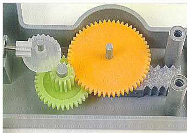
**5** Ora posizioneremo l'ingranaggio a cremagliera. Il braccio ha delle sporgenze, che svolgeranno una funzione di guida per l'ingranaggio, a sua volta dotato di una scanalatura vuota, che dobbiamo fare coincidere con queste sporgenze del braccio. La terminazione ad angolo retto dell'ingranaggio deve rimanere orientata verso l'esterno del braccio.
