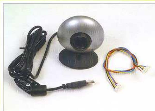
**1** La telecamera Web di Pathfinder è fornita in una scatola con il manuale di istruzioni del costruttore. Per inserirla sul robot dobbiamo togliere il cavo già montato sulla telecamera e sostituirlo con quello fornito di due connettori a cinque vie che vediamo nell'immagine.
