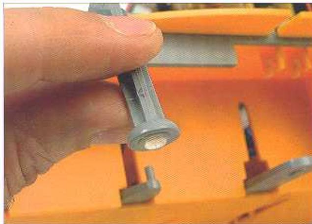
**7** Ripeteremo lo stesso processo di montaggio degli adesivi antiscivolo sulle zampe anteriori del robot. Verranno montati sulla base di appoggio del piede di ogni zampa, facendo pressione sino a ottenere una buona aderenza.
