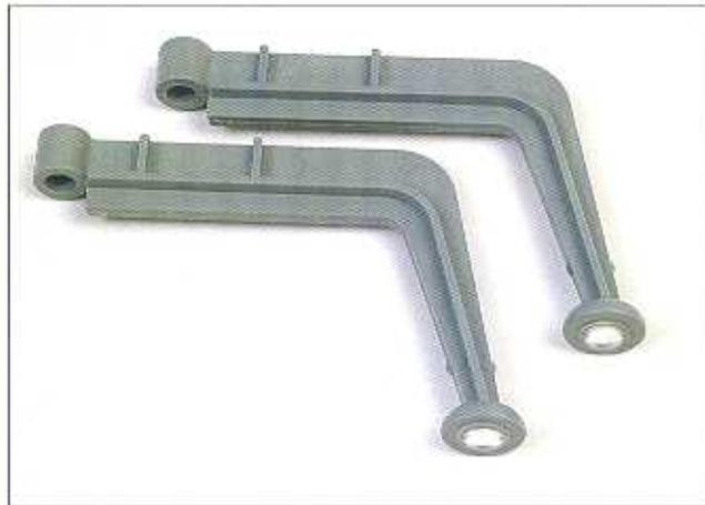
**6** Queste sono le due zampe posteriori del robot con gli adesivi antiscivolo montati. Dopo aver verificato il corretto posizionamento degli adesivi, faremo pressione sugli stessi per migliorare l'aderenza in modo che non si stacchino quando il robot cammina.
