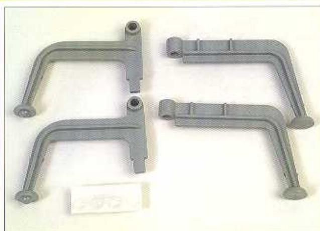
**1** Ora abbiamo a disposizione le quattro zampe di Pathfinder che ci mancavano: con le due anteriori, montate in precedenza, formeranno l'insieme di zampe che permetteranno al robot di spostarsi come un esapodo. Gli adesivi antiscivolo costituiscono i piedi della zampe.
