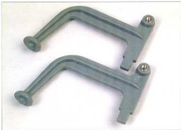
**5** Ora monteremo le due zampe basculanti sul robot. Prima di fissare le zampe sul telaio è necessario inserire i due bulloni rimanenti nei fori presenti sulle zampe nella loro parte superiore.
