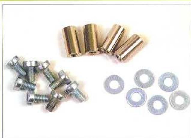
**1** Questi sono i materiali necessari per terminare il montaggio di Pathfinder in modo esapodo. Utilizzeremo i bulloni, le viti e le rondelle per montare le zampe posteriori e quelle basculanti sul telaio di Pathfinder.
