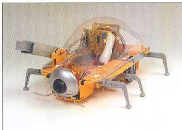
**8** Abbiamo quindi completato il montaggio di Pathfinder. Abbiamo montato tutti gli elementi meccanici e le schede elettroniche necessarie per far funzionare il robot, sia in modo veicolo sia come esapodo. Possiamo anche collegare il robot al PC per gestire il suo controllo e vedere le immagini della telecamera Web.
