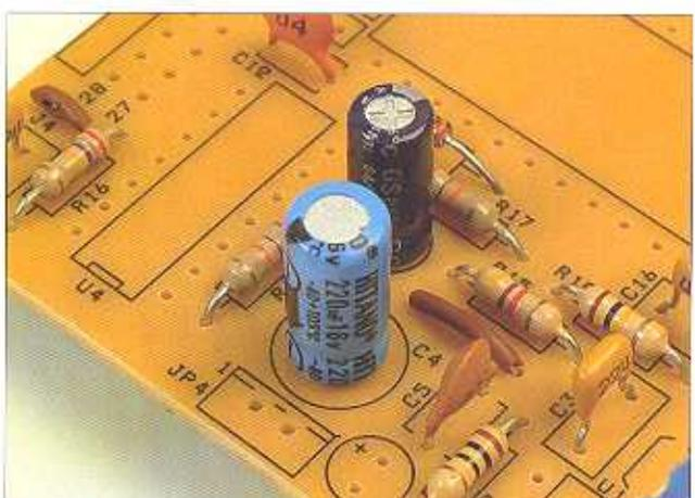
**4** Ora salderemo un condensatore da  $220\ \mu\text{F}$ , anch'esso con il valore scritto sul contenitore. Questo è il condensatore elettrolitico di maggior dimensioni di questa scheda. La sua posizione è C4. Dobbiamo rispettare la polarità facendo coincidere il piedino positivo con il simbolo + della serigrafia.
