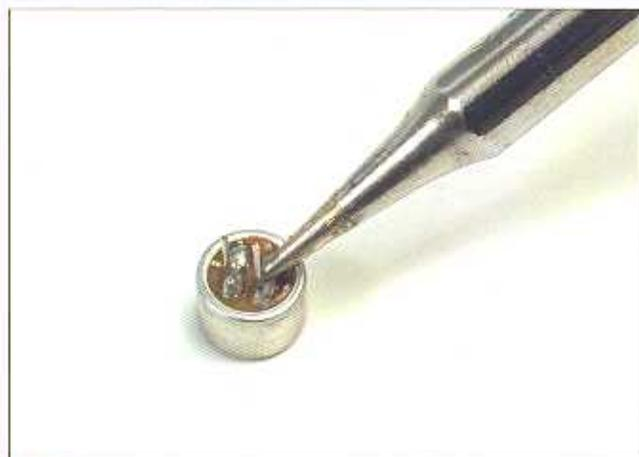
**4** Continueremo montando il microfono della scheda audio, che sarà il componente tramite il quale registreremo i messaggi sul robot. Per saldare il microfono dovremo utilizzare due cavetti o la parte in eccesso dei reofori di qualche componente che avevamo già saldato, come resistenze, condensatori, diodi o transistor.
