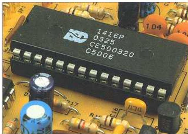
**5** In questa immagine possiamo vedere il chip ISD1416 correttamente inserito sulla scheda audio, sullo zoccolo saldato nella posizione U2. Dobbiamo verificare che l'orientamento del chip sia corretto, altrimenti potremmo danneggiare la scheda quando collegheremo l'alimentazione.
