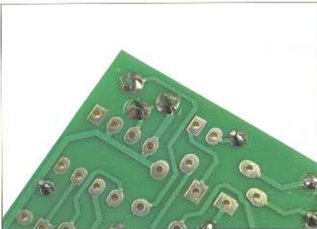
**7** Per saldare il potenziometro correttamente dobbiamo utilizzare una maggiore quantità di stagno rispetto alle saldature delle resistenze. In questo caso non sarà necessario tagliare la parte in eccesso dei piedini dopo aver realizzato le saldature.
