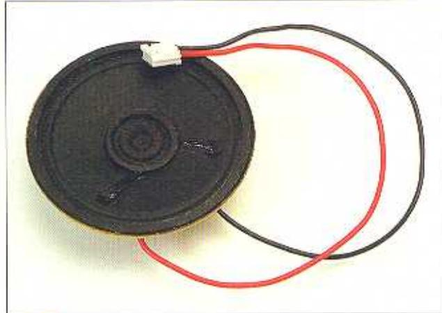
**6** Nell'immagine possiamo vedere l'altoparlante con il montaggio terminato. Il terminale femmina, che ha il connettore saldato all'altoparlante, ci permetterà di cambiare facilmente la posizione dell'altoparlante fra la scheda d'ingressi e uscite e la scheda audio.
