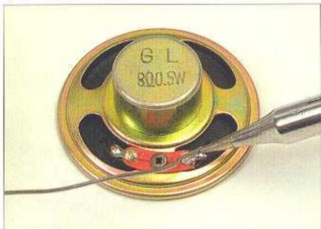
**2** Prima di realizzare le saldature, conviene stagnare i due terminali dell'altoparlante. Dobbiamo evitare che lo stagno tappi i due fori sui terminali, dato che vi dovremo inserire i cavi del connettore.
