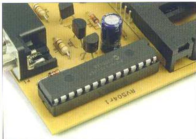
**5** In questa immagine possiamo vedere il microcontroller correttamente inserito nella scheda di scrittura. È importante che sia montato per il verso adeguato, con la sua tacca di riferimento che coincide con quella dello zoccolo. Il microcontroller deve rimanere completamente inserito nello zoccolo, per assicurare una corretta connessione.
