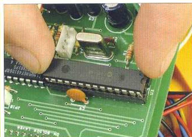
**7** Quando opereremo con il robot, dopo aver programmato il microcontroller sulla scheda di scrittura, lo dovremo montare sulla scheda di controllo di Pathfinder. Il microcontroller sarà inserito nella posizione U3 della scheda di controllo.
