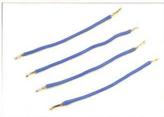
**4** Ora dobbiamo unire i contatti montati nel portabatterie per mettere in serie le cinque batterie che inseriremo, in modo da elevare la tensione. Per fare questo abbiamo a disposizione un filo, che dovremo tagliare in quattro pezzi uguali. Inoltre dovremo pelare e stagnare i due estremi di ogni filo tagliato.
