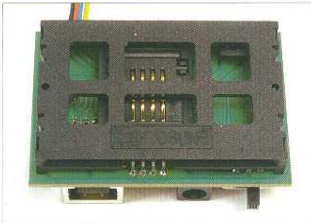
**7** L'immagine mostra la parte anteriore della scheda in cui possiamo vedere lo zoccolo Smartcard correttamente saldato. È importante che il resto dei componenti della scheda di alimentazione sia stato saldato correttamente dato che una volta montato lo zoccolo Smartcard non potremo accedere alle saldature.
