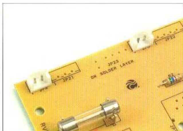
**3** Continueremo montando e saldando un altro connettore maschio da due pin dritto, il suo posto è JP6. Come per il connettore che abbiamo saldato in JP5, lo dobbiamo orientare correttamente, così come si vede nell'immagine. Il lato del connettore con la parete deve essere rivolto verso l'esterno della scheda, e la parte aperta, in cui si vedono i pin, verso l'interno.
