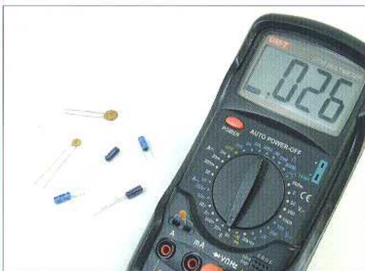
Se per le resistenze potevamo misurare qualsiasi valore, non si può fare altrettanto per la misura dei condensatori. Possiamo solo misurare condensatori di valore inferiore a 20  $\mu\text{F}$ , quindi non potremo misurare i condensatori elettrolitici di grande capacità, il cui valore deve essere verificato osservando il numero scritto sul suo contenitore.
