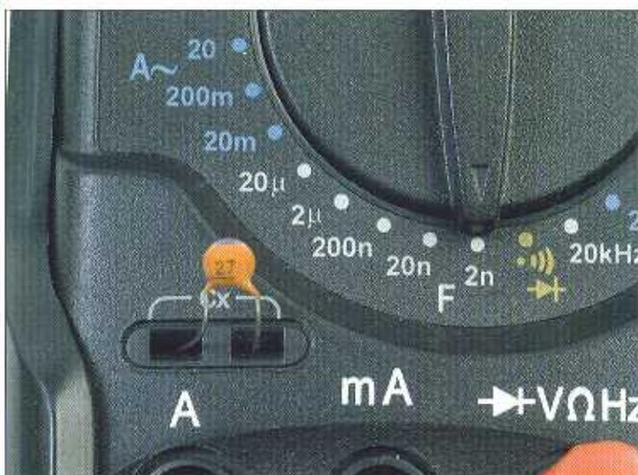
Nell'immagine possiamo vedere un condensatore da 27 pF inserito nei terminali. Alcuni modelli di tester possiedono un adattatore che si inserisce nei terminali di misura e facilita il posizionamento del condensatore. Così come succedeva con le resistenze o con la tensione, dobbiamo posizionare il selettore rotativo sulla scala adeguata per ottenere la misura corretta. Nel caso in cui venga selezionata una scala troppo bassa, il tester visualizzerà il valore 1 nella parte sinistra del display.
