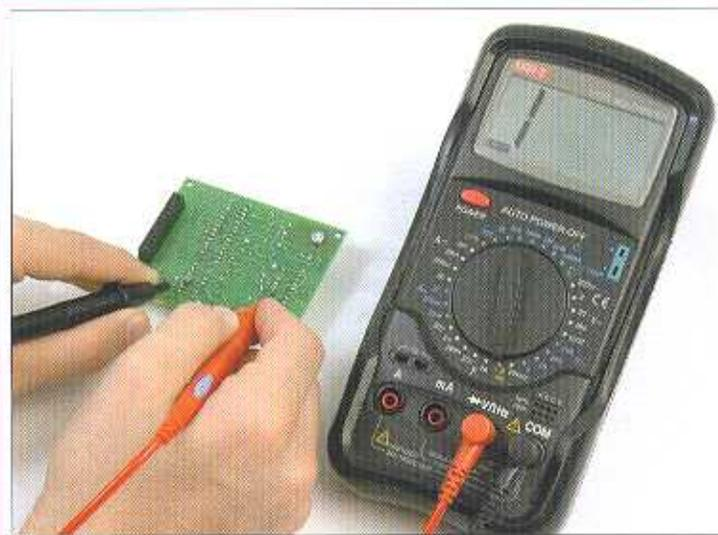
Se posizioniamo il tester tra due punti che non sono uniti, o due punti che dovrebbero essere uniti, però a causa di una cattiva saldatura non lo sono, sul display del tester apparirà il numero 1 e se il tester è sonoro, non emetterà alcun suono. In questo modo possiamo controllare la scheda alla ricerca di cortocircuiti e verificare che le piste conducano ottimamente.
