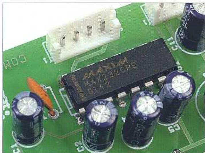
Il circuito incaricato delle comunicazioni con il PC si basa su di un circuito integrato MAX232 e quattro condensatori. Con questi elementi otterremo di adattare i livelli di tensione TTL in uscita del microcontroller ai livelli di tensione più elevati che richiede la porta seriale del PC.
