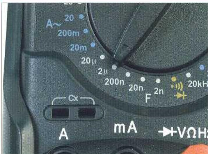
Se vogliamo misurare il valore di un condensatore con il tester, non dobbiamo utilizzare le punte di misura, ma dei terminali speciali, posizionati sul contenitore del multimetro.
