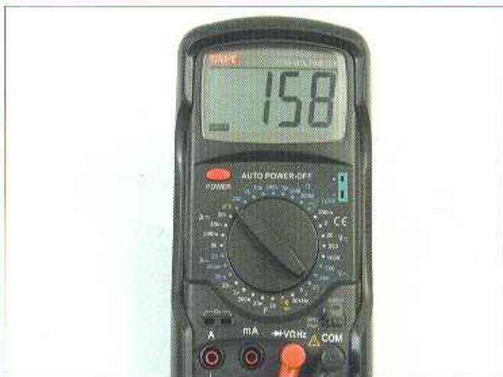
Ora abbiamo il transistor correttamente montato, infatti sul display LCD appare il valore del suo guadagno. Se lo conosciamo già, potremo verificare quali siano la base, l'emettitore e il collettore del transistor, dato che il tester non ne indica il guadagno sino a che il transistor non sia montato correttamente.
