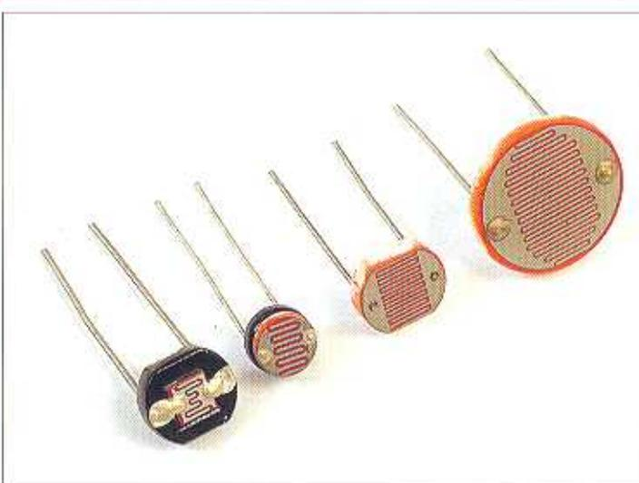
Esistono fotoresistenze di diverse dimensioni e forme, ognuna di esse adatta a una particolare applicazione. Una fotoresistenza è composta da un materiale fotoconduttore la cui resistenza varia in funzione dell'illuminazione che incide su di essa. Tanto maggiore sarà l'intensità di luce che incide sulla superficie, minore sarà la sua resistenza e viceversa. Questi sensori di solito si chiamano LDR (light dependent resistors) o celle fotoconduttrici.
