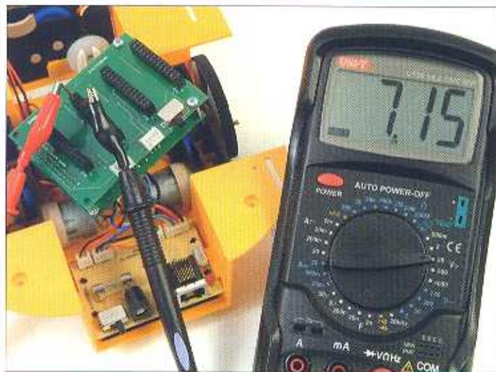
Verifichiamo ora la tensione che arriverà ai motori. Per fare questo posizioneremo il terminale positivo del tester sul pin 26 del connettore JP14 della scheda di interfaccia e il terminale negativo sul pin 20. Sul tester deve apparire la stessa tensione che è fornita direttamente dall'alimentatore. Nel caso si stia alimentando il robot con cinque pile all'interno del porta batterie del telaio la tensione sarà attorno a 7 V.
