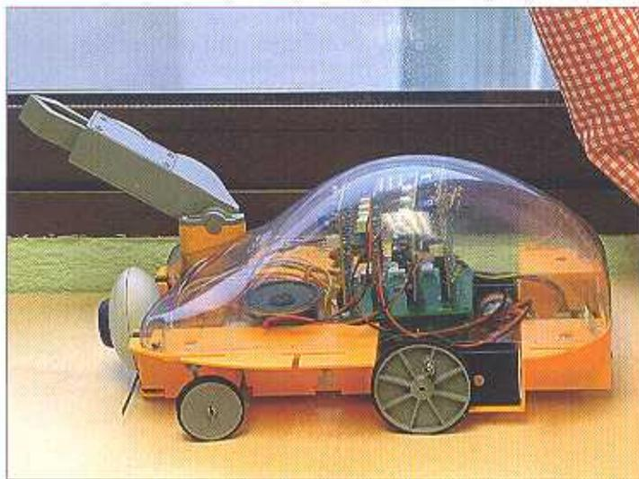
Grazie al sensore di luminosità potremo realizzare diversi lavori con Pathfinder. Per esempio, potremo programmare il robot perché si attivi automaticamente quando si fa giorno e si spenga di notte. Nell'immagine vediamo Pathfinder vicino a una finestra e possiamo programmarlo perché funzioni, parli e veda tramite la sua camera web, solamente quando è giorno.
