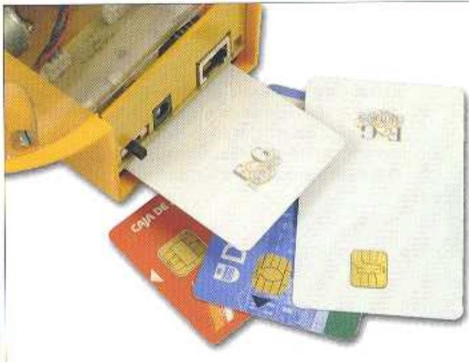
Esistono molte applicazioni commerciali per le Smartcard: controllo di accesso e di presenza, pagamenti elettronici, trasporti, identificazione e sicurezza in informatica, sanità, processi industriali, ecc. Nel caso di Pathfinder la scheda chip servirà per immagazzinare i programmi e gli algoritmi di funzionamento del robot. I programmi saranno scritti sulla Smartcard. In seguito, introducendo la scheda nel robot, quest'ultimo eseguirà il programma corrispondente.
