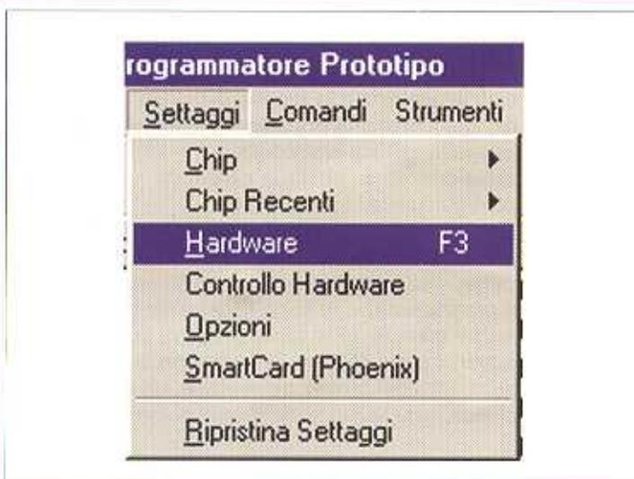
Se avremo bisogno di cambiare la configurazione del nostro hardware, potremo accedere al menù di configurazione originale, che abbiamo utilizzato la prima volta quando abbiamo eseguito Icprog. Per fare questo bisogna andare al menù "Settaggi" e selezionare l'opzione "Hardware". Si aprirà il menù di configurazione che già conosciamo, e in cui potremo selezionare una nuova porta del PC o apportare modifiche alla nostra configurazione hardware.
