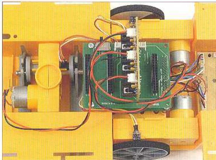
Analizzeremo ora la meccanica di Pathfinder, sia nella configurazione con le ruote che con le zampe. Per ottenere entrambi i tipi di movimento, il robot è stato dotato di tre motori. Tutti i motori hanno associata una cassa di riduzione, che trasmette sufficiente potenza ai movimenti.
