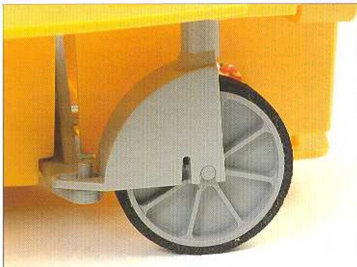
Le ruote anteriori di Pathfinder non generano movimento, servono solo per il controllo della direzione. Sono delle ruote di minor dimensione rispetto a quelle posteriori e saranno unite mediante un asse, in modo che entrambe sterzino sempre nello stesso senso. Così come in un veicolo convenzionale, mediante questa configurazione delle ruote, il robot non potrà girare su se stesso, per cui dovrà eseguire delle manovre nelle curve più strette.
