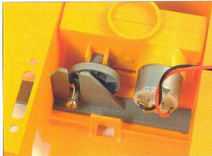
Il motore centrale utilizzerà un traslatore, o guida, per trasmettere il movimento alle ruote. Questo traslatore, si incastrerà sul bullone che fuoriesce dall'eccentrico unito all'asse della scatola di riduzione. In questo modo, il movimento di rotazione verso sinistra o verso destra del motore, si converte in un movimento di traslazione verso sinistra o destra mediante questa guida.
