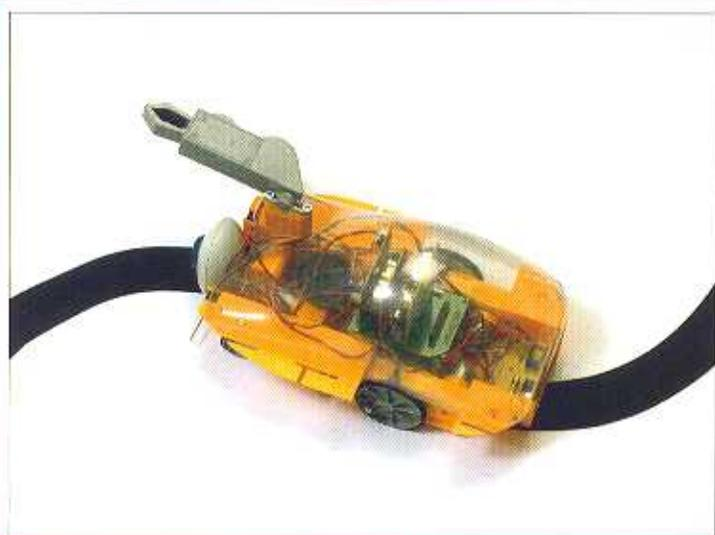
Grazie a questi sensori ottici il robot potrà eseguire delle operazioni spostandosi lungo un percorso disegnato sul pavimento. Con i sensori ottici potremo distinguere facilmente una linea nera su qualsiasi superficie mediamente riflettente. Quando rileviamo che il robot sta uscendo dal percorso, il motore centrale entrerà in funzione correggendo la posizione delle due ruote anteriori di direzione, in modo che il robot torni a posizionarsi sulla striscia.
