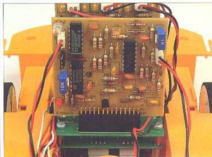
A differenza del resto dei sensori del robot il sensore di luminosità è un sensore analogico: il segnale inviato da RA0 non disporrà dei due valori, "1" e "0" logico, ma di qualsiasi valore compreso fra 0 e 5 V. Quando la scheda dei sensori viene inserita sulla scheda di interfaccia, il fototransistor rimarrà nella zona superiore del robot, in modo da poter captare perfettamente la luce ambientale.
