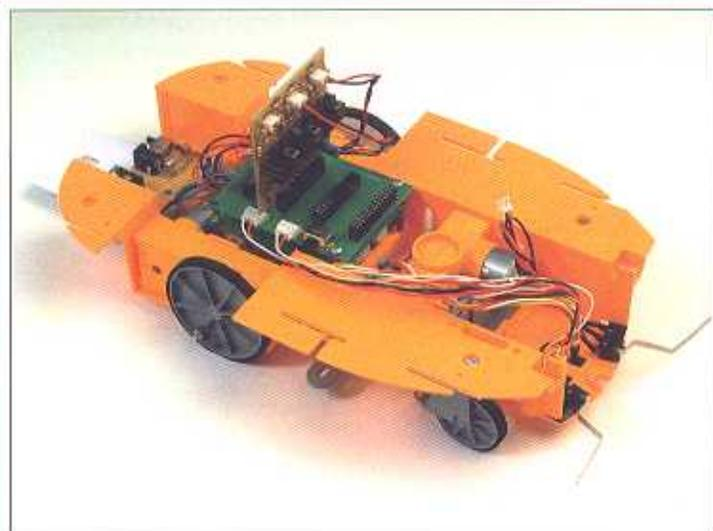
È necessario che la scheda di potenza sia inserita sulla scheda di interfaccia sul connettore JP4 con lo stesso orientamento che possiamo vedere dall'immagine. Il motore destro sarà sul connettore JP2 di questa scheda e il motore sinistro sul connettore JP4. Il finecorsa sinistro si deve trovare sul connettore JP7 della scheda di interfaccia, il finecorsa destro su JP8. Il commutatore SW2 deve essere posto sulla posizione di attivazione dei finecorsa, come possiamo vedere nell'immagine.
