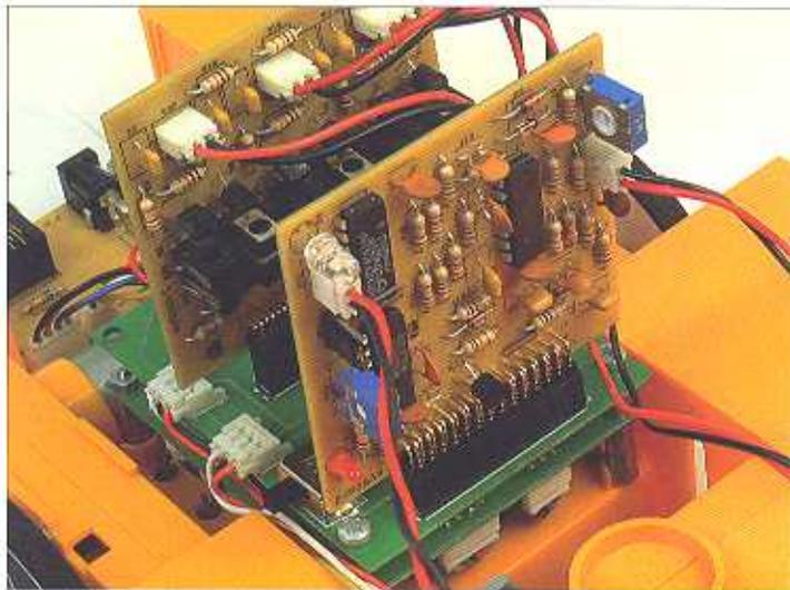
La scheda dei sensori verrà inserita sul robot mediante la scheda di interfaccia, tramite il connettore femmina JP16. Bisognerà inserirla con lo stesso orientamento mostrato dall'immagine. I segnali dei pin RA1 e RA2 non viaggiano diretti da questo connettore sino al microcontroller, ma passano tramite il commutatore doppio SW2 della scheda di interfaccia, per poter selezionare se utilizzare gli ultrasuoni o i finecorsa.
