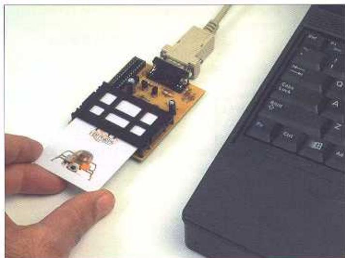
Dobbiamo scrivere il codice sorgente del programma mediante il software MPLAB. Memorizzeremo il file con il nome pot3.asm e lo compileremo per ottenere il file pot3.exe. Il file esadecimale verrà scritto sulla Smartcard utilizzando il software di programmazione e la scheda di scrittura. Dopo aver realizzato la programmazione, caricheremo la Smartcard sulla scheda di alimentazione del robot.
