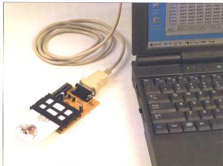
Dopo aver scritto il programma, lo compileremo mediante il software MPLAB. Dopo aver ottenuto il file .hex senza errori, utilizzeremo il programma ICPROG e la scheda di scrittura per caricarlo sulla Smartcard. Come per il resto degli esercizi del robot, il programma uploader dovrà già essere presente sul microcontrollore, e quest'ultimo dovrà essere inserito sulla scheda di controllo.
