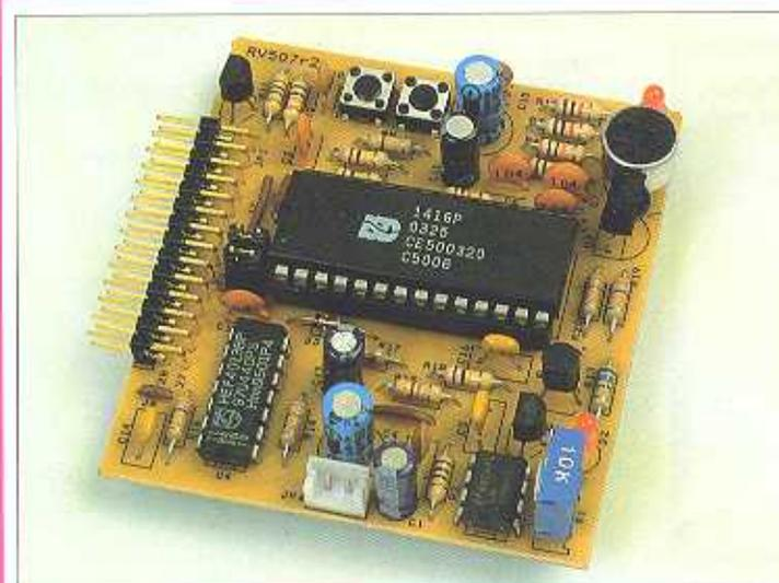
Con questo e alcuni esercizi dimostrativi del suo funzionamento, terminiamo l'analisi della scheda audio. È facile realizzare esercizi che combinino audio e infrarossi e includere queste funzioni nel controllo dei motori per il resto delle periferiche di Pathfinder. Mediante la scheda audio e il microfono che essa contiene acquisiremo il suono proveniente dall'ambiente, che sarà poi inviato verso il PC per poterlo udire negli altoparlanti del computer.
