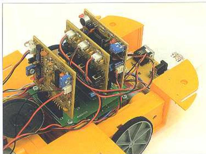
Questo esercizio gestisce i due motori posteriori e il sensore a infrarossi. Dobbiamo collegare la scheda di potenza con il connettore JP14 della scheda di interfaccia, così come i motori. La scheda audio rimarrà sul connettore JP13. L'orientamento della scheda deve essere quello corretto, così come mostrato nell'immagine. La scheda dei sensori può anche rimanere inserita nel suo posto, il connettore JP16.
