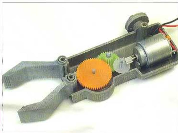
Questo è il meccanismo di controllo della pinza. Come potete osservare, il movimento del motore è collegato a una serie di corone sino ad arrivare a una cremagliera, che avrà il compito di trasmettere il movimento alla pinza. I movimenti di temporizzazione necessari per l'attivazione di questo meccanismo, li controlla il microcontroller PIC12C508, quindi dovremo solamente inviare gli impulsi tramite il piedino RA3 del microcontroller della scheda di controllo per iniziare il movimento.
