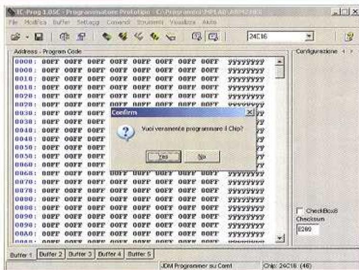
Una volta ottenuto il file esadecimale, utilizzeremo ICPROG per la programmazione della Smartcard (dispositivo 24C16), utilizzando la scheda di scrittura collegata al PC. Dopo aver scritto la Smartcard, la inseriremo nella scheda di alimentazione di Pathfinder. Ogni volta che utilizziamo la Smartcard dobbiamo fare attenzione al verso di inserzione, dato che deve essere inserita con l'orientamento corretto.
