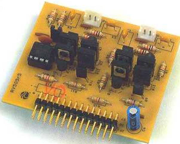
Analizzeremo ora l'ultima scheda di Pathfinder, la scheda di controllo del braccio. Questa scheda gestirà il movimento di salita e discesa del braccio di Pathfinder e inoltre l'apertura e chiusura della sua pinza. Sarà in comunicazione con il microcontroller tramite la scheda di interfaccia. Possiede un microcontroller PIC12C508 che ha il compito di controllare i movimenti della pinza.
