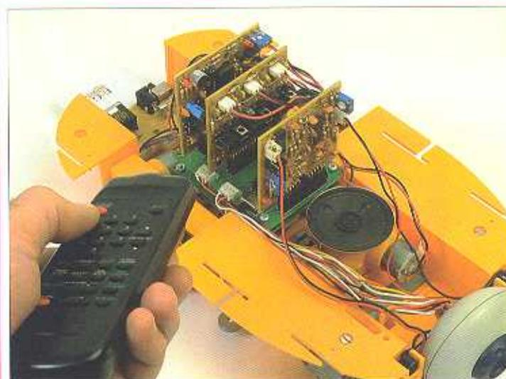
Per verificare l'esercizio alimenteremo il robot e utilizzeremo un normale telecomando. Il microcontroller impiegherà qualche secondo per leggere il contenuto della Smartcard. A ogni impulso del telecomando potremo veder cambiare lo stato del LED D2 della scheda audio. Quando il LED sarà acceso, i due motori posteriori del robot, si attiveranno, e quando il LED rimarrà spento, i motori si fermeranno.
