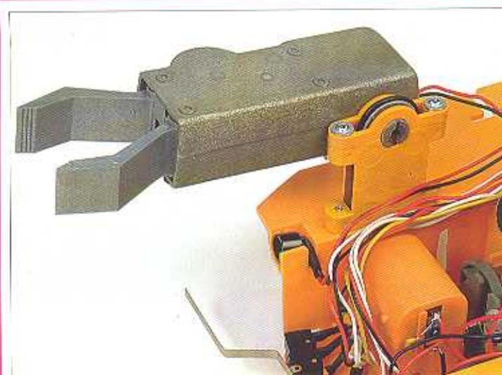
In questa immagine possiamo vedere il braccio e la pinza di Pathfinder montati sul telaio. Il braccio avrà un movimento di salita e discesa fra due posizioni fisse. All'interno del braccio si trova il motore di controllo della pinza e tutto il meccanismo necessario per convertire i movimenti di rotazione del motore in movimento di apertura e chiusura della pinza.
