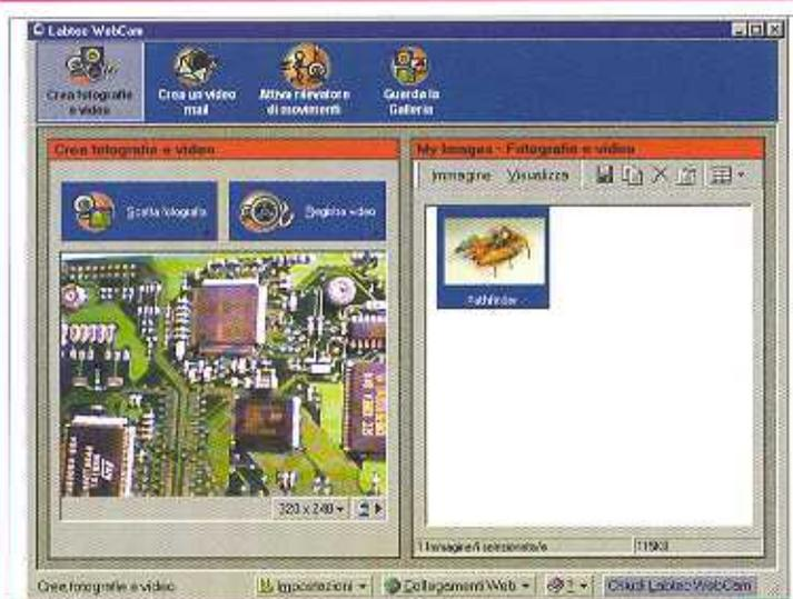
Analizziamo il funzionamento del software di controllo della telecamera WEB che verrà montata sulla parte frontale di Pathfinder. In questa immagine possiamo vedere la videata principale del programma, a cui si accede cliccando il primo pulsante della parte superiore sinistra, che ha come titolo "Crea fotografie e video". Appariranno altre due finestre, una con l'immagine che attualmente sta captando la telecamera, e l'altra con le immagini acquisite.
