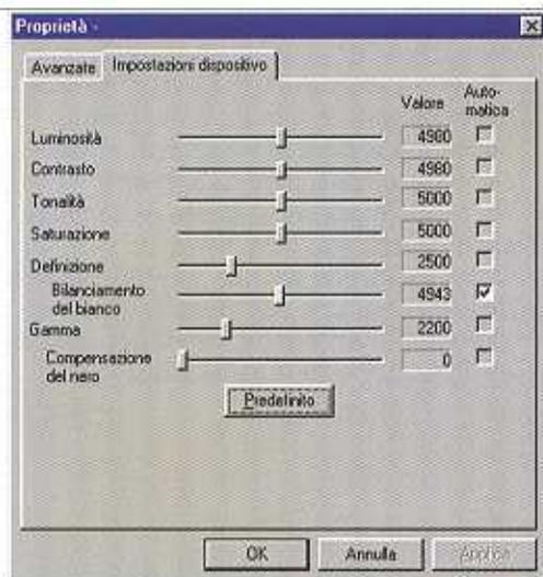
Nel menù di configurazione avanzata abbiamo accesso anche alle configurazioni avanzate della telecamera, in cui è possibile modificare manualmente i livelli di luminosità, contrasto, saturazione, definizione ecc. Convienne lasciare tutti i valori a livelli medi, salvo il caso in cui ci si trovi in ambienti con condizioni di luminosità che richiedano di modificare qualche parametro dell'immagine mostrata dalla telecamera.
