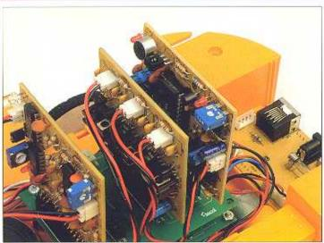
Come possiamo vedere nell'immagine, il sensore a infrarossi è posizionato sulla zona superiore della scheda in modo da poter captare i segnali a infrarossi che arrivano da qualsiasi telecomando.
