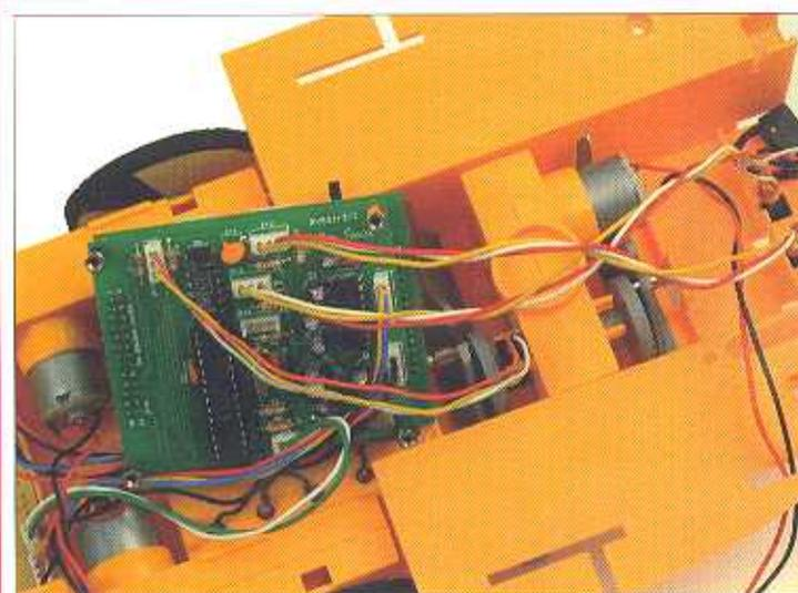
Per ultimo collegheremo il sensore ottico CNY70, che è l'altro sensore della parte anteriore del telaio ed è montato sulla parte destra. Questo sensore verrà collegato sul connettore JP7 della scheda di controllo. I connettori hanno solo un verso di inserzione corretto, e dispongono di alcuni impedimenti meccanici mediante i quali è permessa l'inserzione solo nell'orientamento adeguato.
