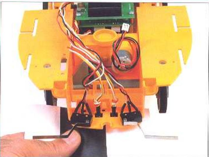
Per attivare un sensore ottico è necessario porre di fronte al sensore stesso una superficie riflettente, idealmente di colore bianco. Possiamo anche attivare il sensore mettendoci davanti un dito. Quando il sensore si trova di fronte a una superficie nera, o semplicemente non ha nulla davanti, si disattiva. Ogni volta che un sensore si attiva, il motore corrispondente si metterà in marcia.
