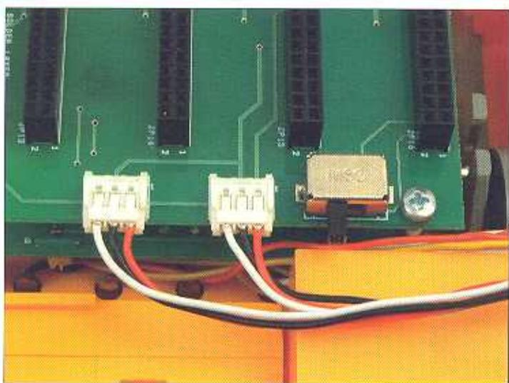
A lato dei connettori per i finecorsa sulla scheda di interfaccia troviamo il commutatore a due vie SW3. Questo commutatore serve a fare in modo che il robot funzioni con i sensori meccanici tipo finecorsa o con i sensori a ultrasuoni. Nei primi esercizi utilizzeremo i finecorsa. Per fare in modo che i finecorsa siano attivi la posizione del commutatore deve coincidere con quella mostrata nell'immagine.
