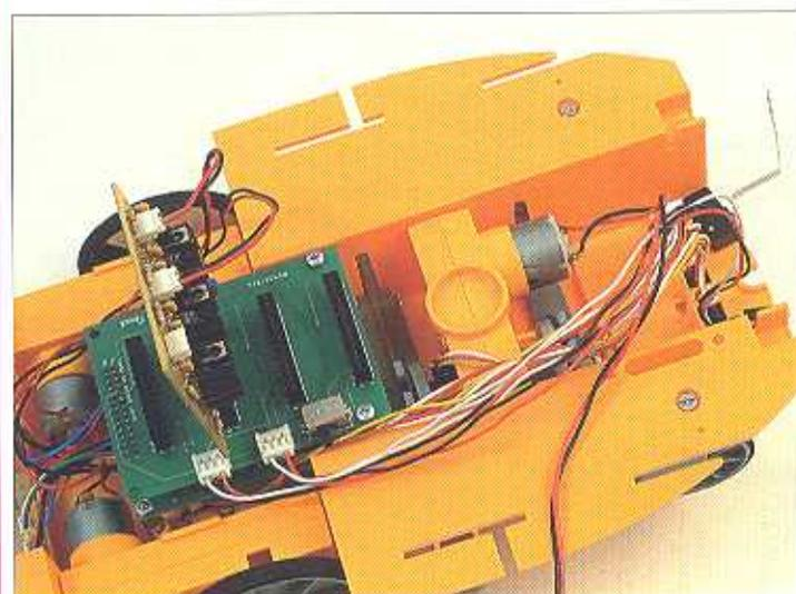
Il finecorsa sinistro deve essere inserito sul connettore JP7 della scheda di interfaccia, la posizione del commutatore SW2 della scheda di interfaccia deve essere la stessa di quella che appare nell'immagine, in modo che i segnali dei finecorsa siano attivi verso il microcontroller della scheda di controllo.
