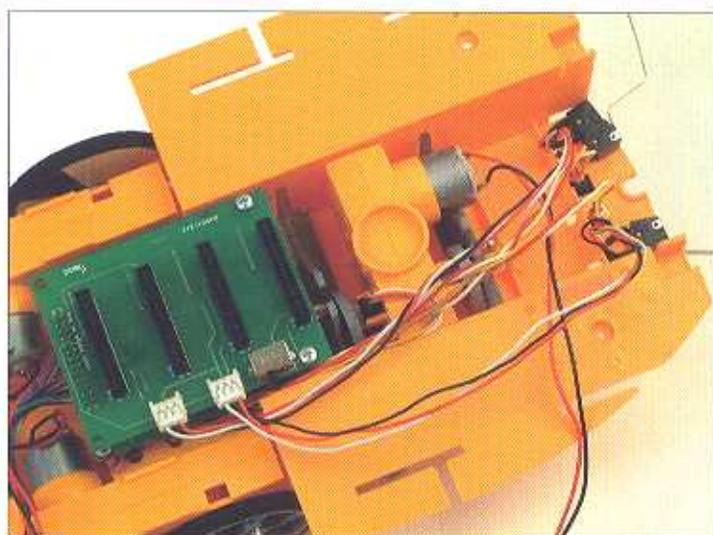
Infine l'ultimo sensore tipo finecorsa è quello situato sulla parte destra del robot. Si collegherà al connettore JP8 della scheda di interfaccia. Questi connettori così come i sensori ottici CNY70, accettano solo il collegamento con l'orientamento corretto. Il finecorsa sinistro comunicherà con il pin RA1 del microcontroller, mentre il finecorsa destro invierà il suo stato al pin RA2.
