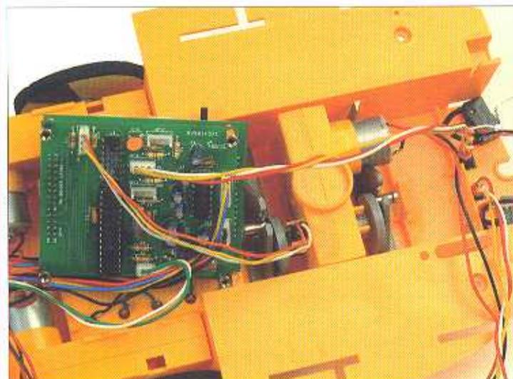
Collegheremo ora gli altri due sensori ottici che abbiamo montato nella parte anteriore del telaio del robot. Il riferimento per distinguere se il sensore è sinistro o destro consiste nel guardare il robot dalla sua parte posteriore. Il sensore situato nel foro sinistro del telaio si collegherà al connettore JP12 della scheda di controllo.
