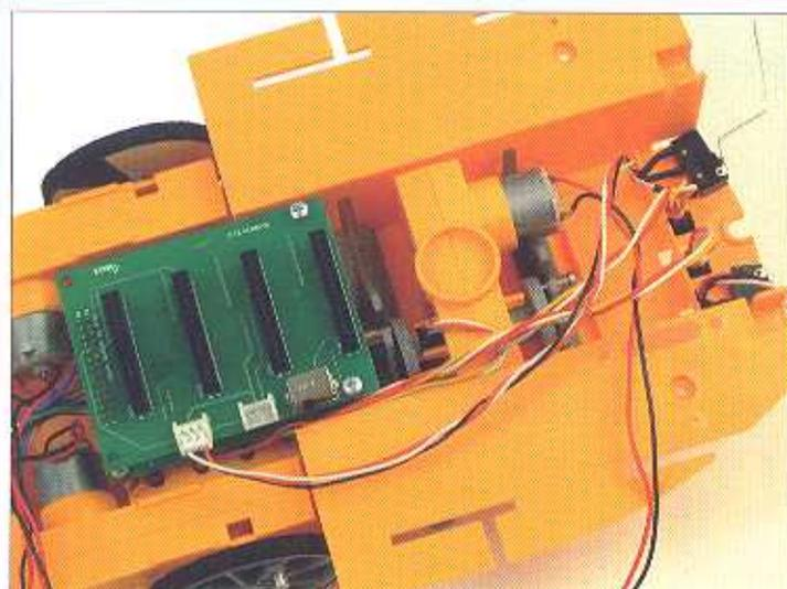
Ora collegheremo i sensori meccanici tipo finecorsa. Per distinguere il sensore sinistro dal destro utilizzeremo lo stesso riferimento dei sensori ottici, cioè osserveremo il robot dalla sua parte posteriore. Il sensore finecorsa sinistro verrà collegato al connettore JP7 posizionato sulla scheda di interfaccia.
