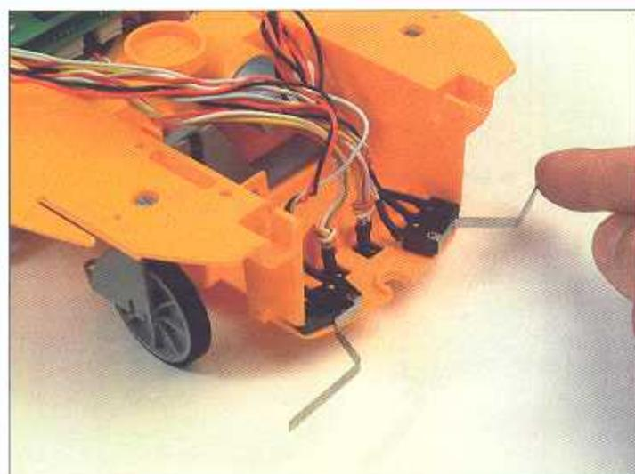
Attiveremo i due finecorsa per far accendere i motori in un verso di rotazione oppure nell'altro. Vi consigliamo di utilizzare un alimentatore esterno da 6 volt collegato tramite il connettore J1 della scheda di alimentazione. Potremo anche utilizzare un gruppo di pile grazie al portabatterie del robot.
