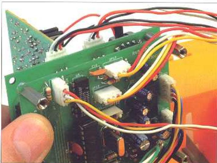
Per provare l'esercizio, la scheda di potenza deve essere inserita sul connettore JP14 della scheda di interfaccia. Non ci deve essere nessun'altra scheda montata sulla scheda di interfaccia. Il motore destro sarà collegato al connettore JP2 della scheda di potenza, e il motore sinistro al connettore JP4. Il sensore ottico sinistro sarà collegato al connettore JP12 della scheda di controllo, e il sensore ottico destro al connettore JP17 della stessa scheda.
