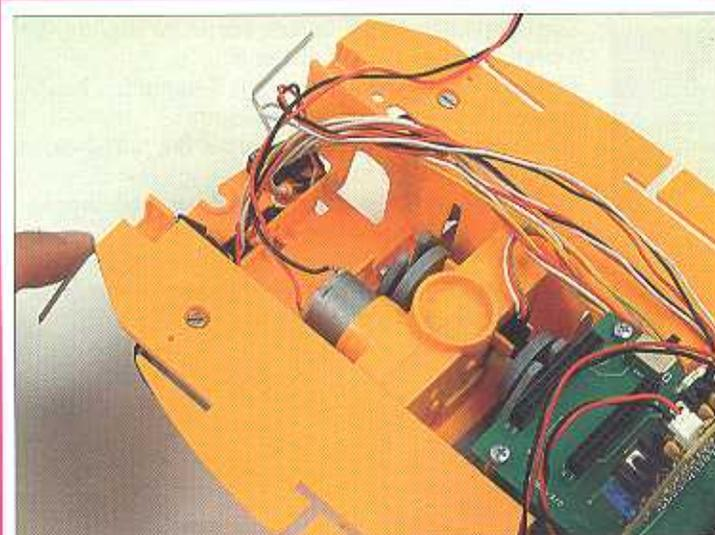
Dopo aver scritto il programma pot1.hex sulla Smartcard la inseriremo nella scheda di alimentazione del robot. Dobbiamo alimentare il robot mediante cinque pile collocate nel porta batterie o con un alimentatore esterno avente un'uscita di circa 6 V. Quando il microcontroller legge il contenuto della Smartcard inizierà l'esecuzione del programma, attivando il finecorsa sinistro i motori cominceranno a girare e rilasciando il finecorsa si fermeranno.
