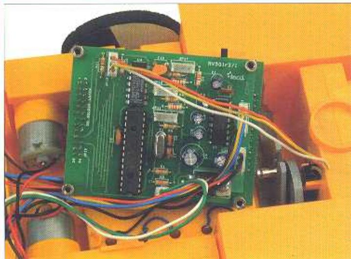
Inizieremo realizzando alcuni programmi di apprendimento con i motori e sensori di Pathfinder. Per questo avremo bisogno di utilizzare la scheda di potenza che abbiamo già montato. Però prima di realizzare i programmi il primo passo consisterà nel collegare adeguatamente i sensori alle diverse schede del robot. Il primo sensore da collegare sarà il sensore ottico CNY70, che abbiamo montato per il controllo del motore centrale e che si collegherà sul connettore JP18 della scheda di controllo.
