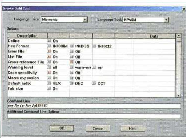
Dobbiamo scrivere il codice sorgente utilizzando il programma MPLAB. Dopo averlo scritto lo memorizzeremo con il nome pot1.asm, dobbiamo compilare il programma senza errori, al fine di ottenere il file pot1.hex; che sarà il file da scrivere sulla Smartcard utilizzando per questo il programma ICPROG. Il procedimento per la programmazione è lo stesso che abbiamo utilizzato per tutti gli esercizi di apprendimento con la scheda di ingressi e uscite.
