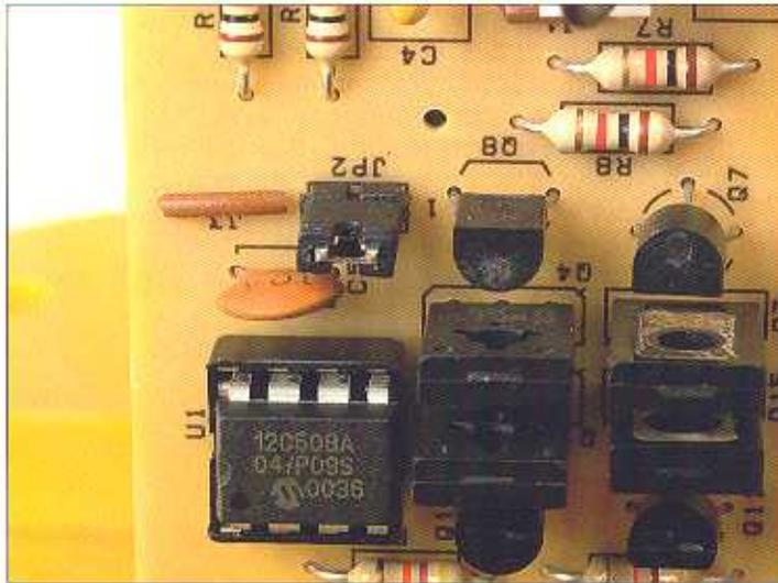
Per provare l'esercizio, la scheda di controllo del braccio e della pinza dovrà essere collegata sulla scheda di interfaccia. Il ponticello JP2 della scheda di controllo del braccio dovrà essere chiuso, come si può vedere nell'immagine. In questo modo il microcontroller specifico PIC12C508, presente sulla scheda, farà funzionare la pinza in modo temporizzato. Infine, il motore di controllo della pinza dovrà essere collegato al connettore JP4 della scheda.
