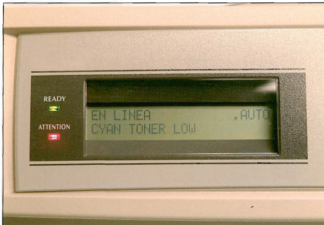
Sistema che utilizza un display LCD come periferica di uscita.
