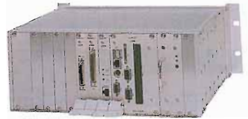
Unità Centrale di Processo AXIOM CompactPCI di un computer dedicato al lavoro in ambienti industriali.
