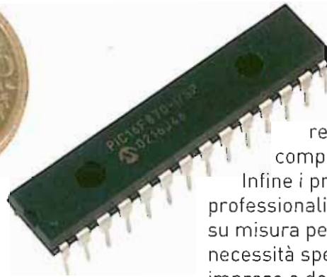
Microcontroller che utilizzerà Pathfinder a fianco di una moneta da 1 euro. All'interno del microcontroller esistono tutti i transistor necessari per costruire un computer.
