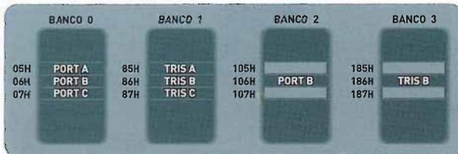
Posizione dei registri di controllo e dei dati delle porte A, B e C del PIC16F870.
