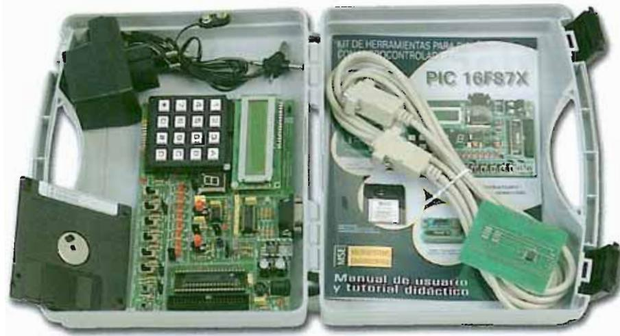
"LABORATORY 87X", progettato per semplificare e facilitare enormemente lo sviluppo dei progetti con il PIC16F87X.
