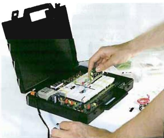
Scheda di programmazione per i PIC16F87X denominata PROTO'PIC2 inserita nella sezione di montaggio del Laboratorio Universal Trainer.
