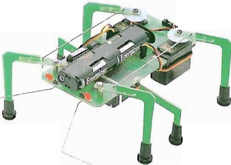
Le due antenne del microrobot rilevano gli ostacoli ai lati della traiettoria e generano un segnale a cui viene data immediata risposta producendo un'azione atta a schivare l'ostacolo.
