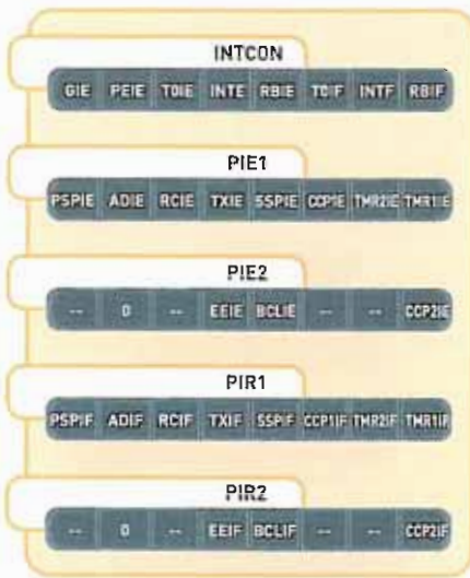
Struttura interna dei cinque registri usati negli interrupt.
