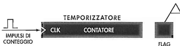
**Struttura generale di un temporizzatore.**
