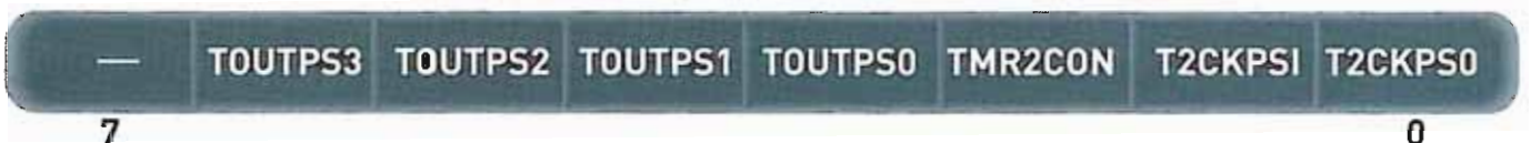
Struttura interna del registro T2CON per la gestione del TMR2.
