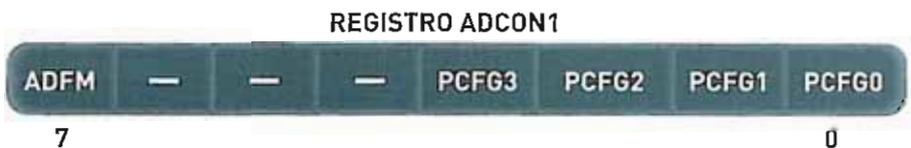
Struttura interna dei registri di controllo ADCON0 e ADCON1.
