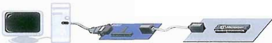
Il modulo ICD permette la messa a punto in circuit e in tempo reale dei progetti basati sui PIC16F87X.
