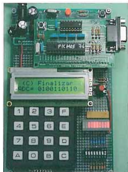
Un PICMOS'76, con il programma scritto, controlla un'applicazione di livello medio su una scheda dei prototipi PIC ME 28.
