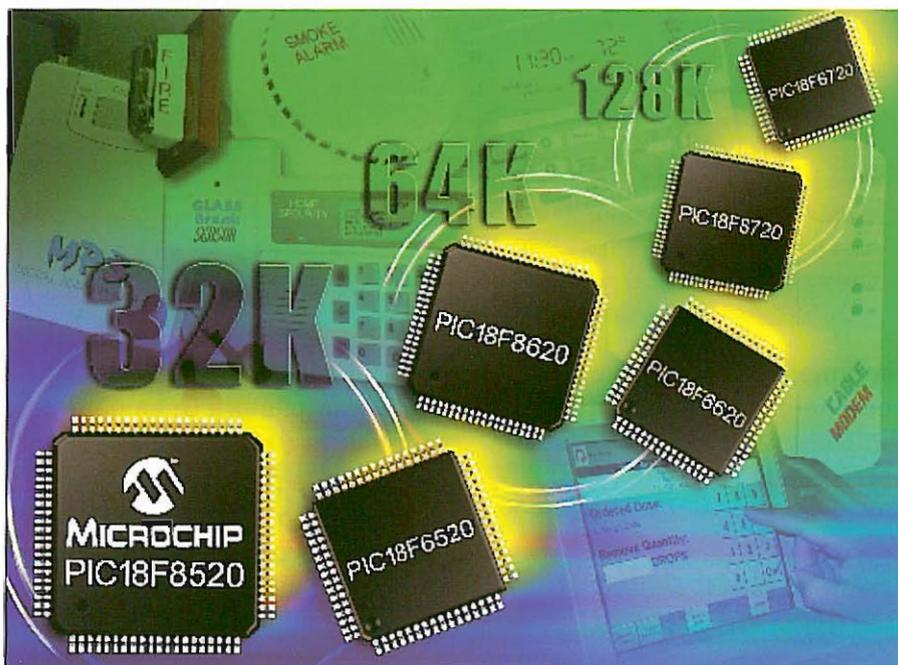
Alcuni modelli della gamma migliorata hanno una capacità di 64K x 8 di memoria interna di programma.
