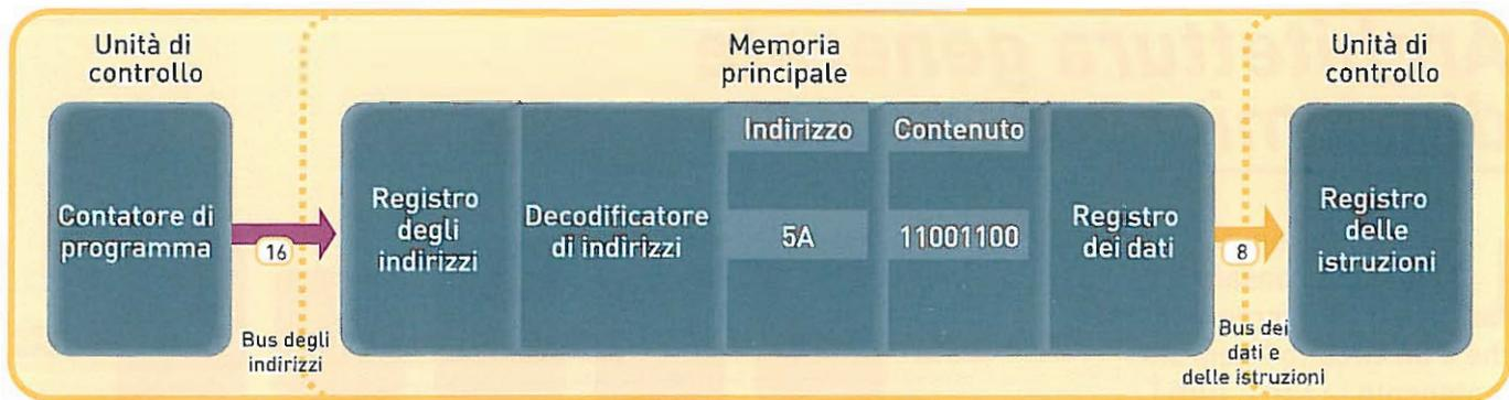
**Nella ricerca di un'istruzione il contatore di programma fornisce l'indirizzo, e il registro delle istruzioni contiene il codice binario della stessa.**
