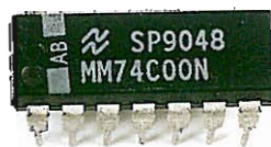
74C CMOS compatibili con TTL.
