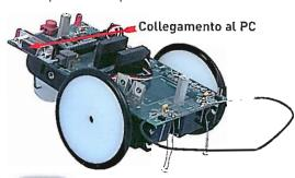
In alcuni microrobot è possibile scaricare il programma tramite un cavo collegato al computer.
