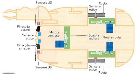
Lo schema elettronico sī trasforma in un disegno schematico del microrobot.
