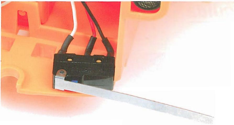
Fotografia di un sensore tipo finecorsa sul microrobot.
