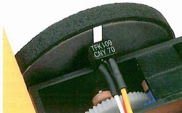
Sensore utilizzato come "encoder".
