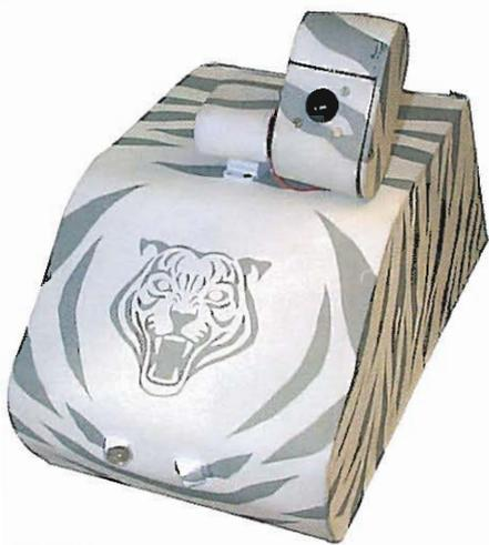
**Microrobot con due motori per muovere la telecamera di cui è dotato.**
