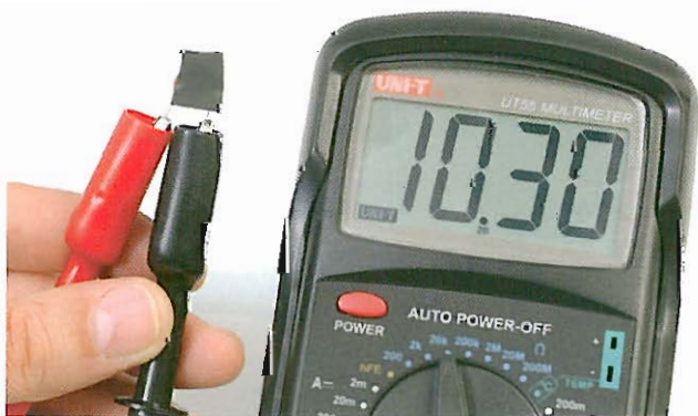
La resistenza di una LDR si può verificare direttamente con il tester.
