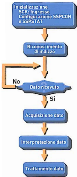
Organigramma base del processo di ricezione dei dati da un PIC slave.
