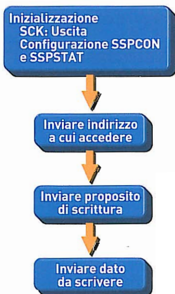
Organigramma base del processo di scrittura da un PIC master.
