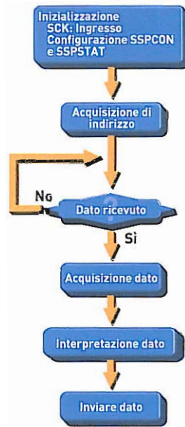
Organigramma base del processo di invio dei dati da un PIC slave.
