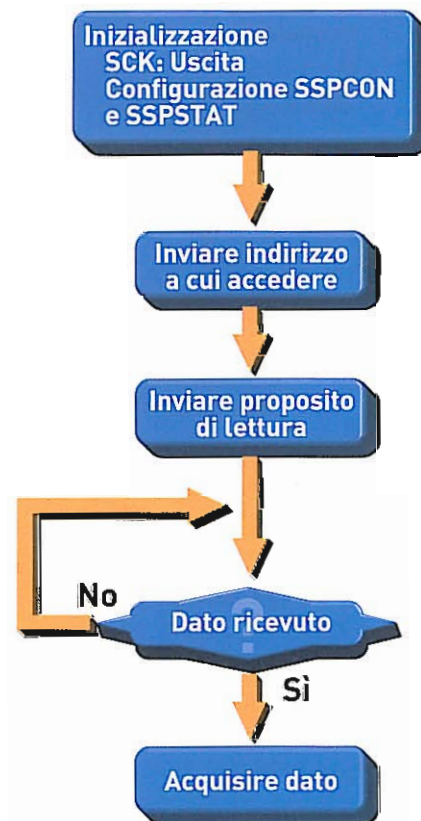
Organigramma base del processo di lettura tramite un PIC master.
