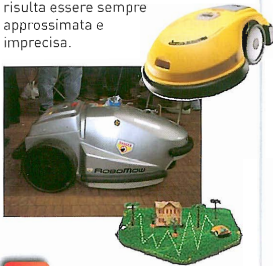
Robomow è il primo tagliaerba intelligente del mondo. Totalmente robotizzato con la tecnologia avanzata SharpScan, non solo taglia in linea retta perfetta, ma riconosce ed evita gli ostacoli.
