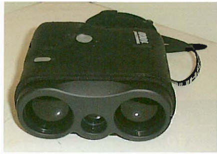
Dispositivo per realizzare misure con l'utilizzo della tecnologia laser.
