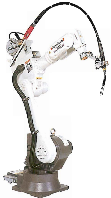
Fotografia di un robot esclusivo per lavori di saldatura VR-006 CEIII di Panasonic.
