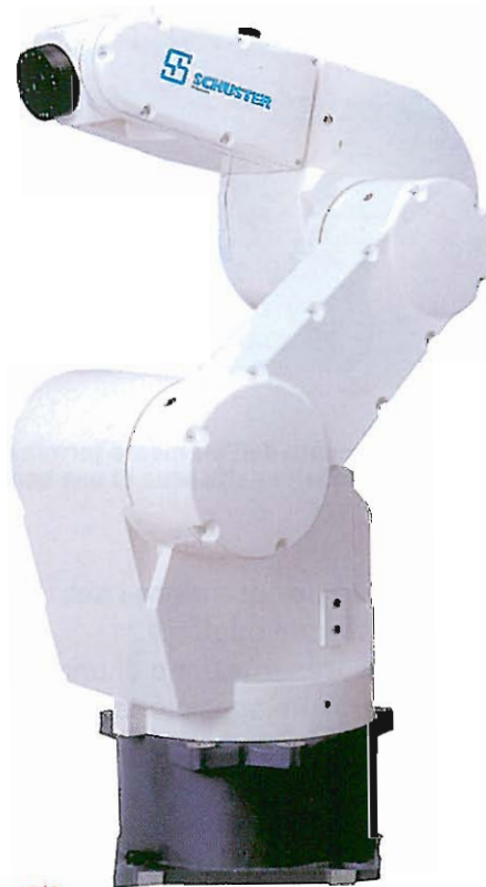
Fotografia di un manipolatore "Shuster" con sei assi di rotazione.
