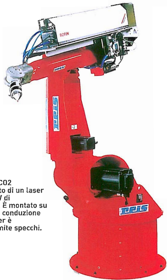
Un robot laser Nd:YAG della ditta REIS.
