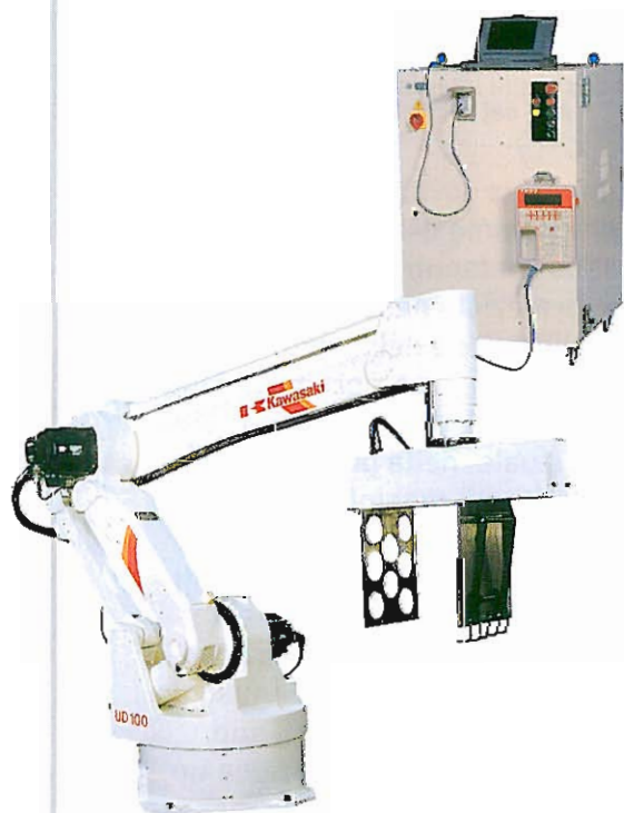
Robot UD100 di Kawasaki formato dal manipolatore, con elemento terminale appropriato, e il controller con la pistola di programmazione manuale e il terminale per la programmazione testuale.
