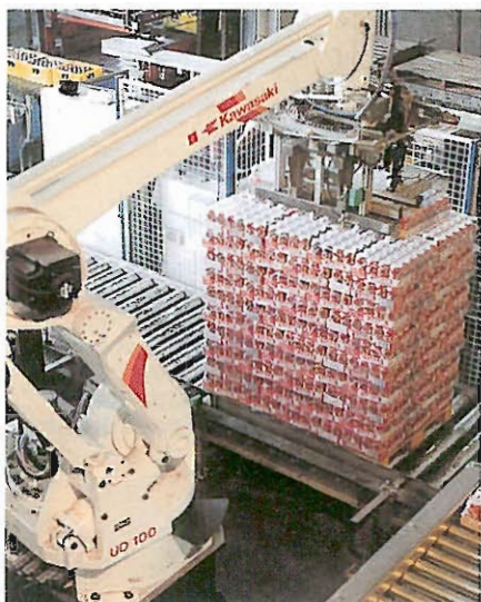
Un robot Kawasaki UD100 per la composizione dei pallet di bottiglie e lattine di birra fasciate con guaina termoretrattile.
