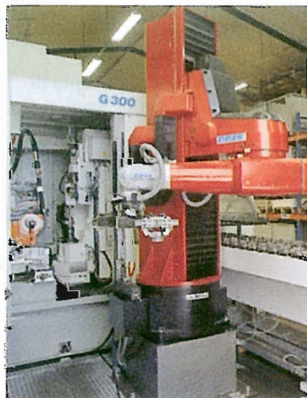
Carico e scarico di una rettificatrice, eseguito con un sistema robotizzato di Reis Robotics.
