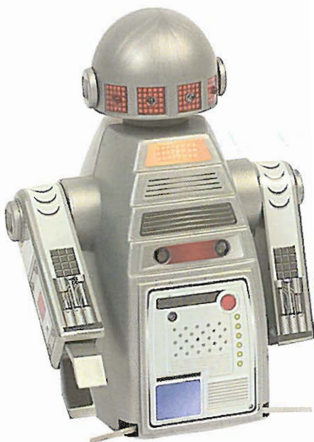
Monty governato da un microcontroller PIC16F84.
