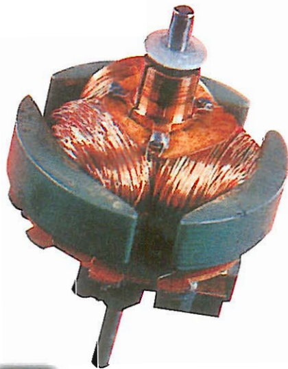
Struttura interna di un motore a corrente continua in cui si può vedere l'avvolgimento dell'indotto avvolto attorno al magnete permanente dell'induttore.
