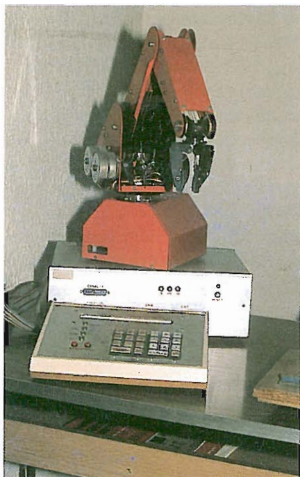
Robot didattico ARMDROID con braccio articolato.
