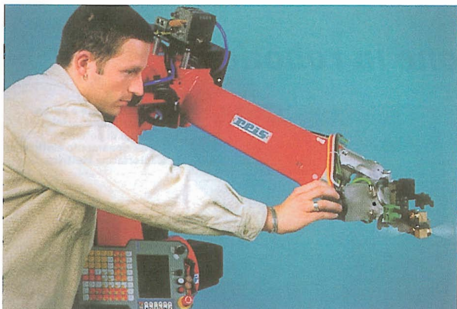
Mouse 6D montato sul robot per la programmazione gestuale diretta in un robot di Reis Robotic.
